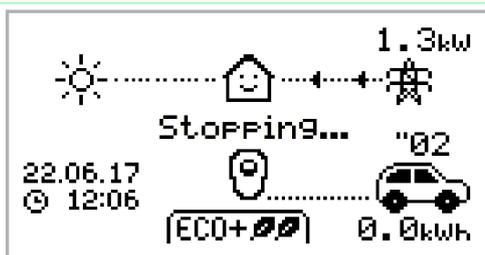
zappi sta per interrompere la ricarica del veicolo elettrico
